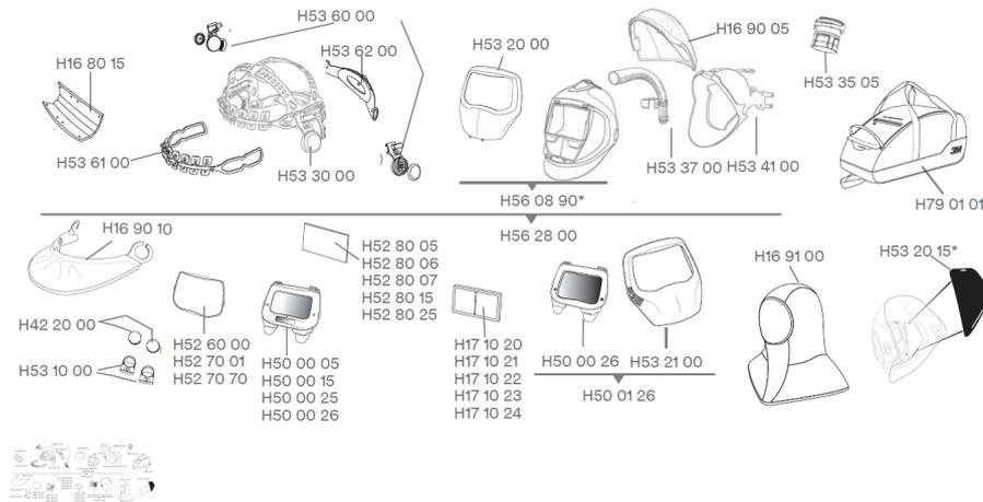
3M Speedglas 9100 Air Automatikschweissmaske
