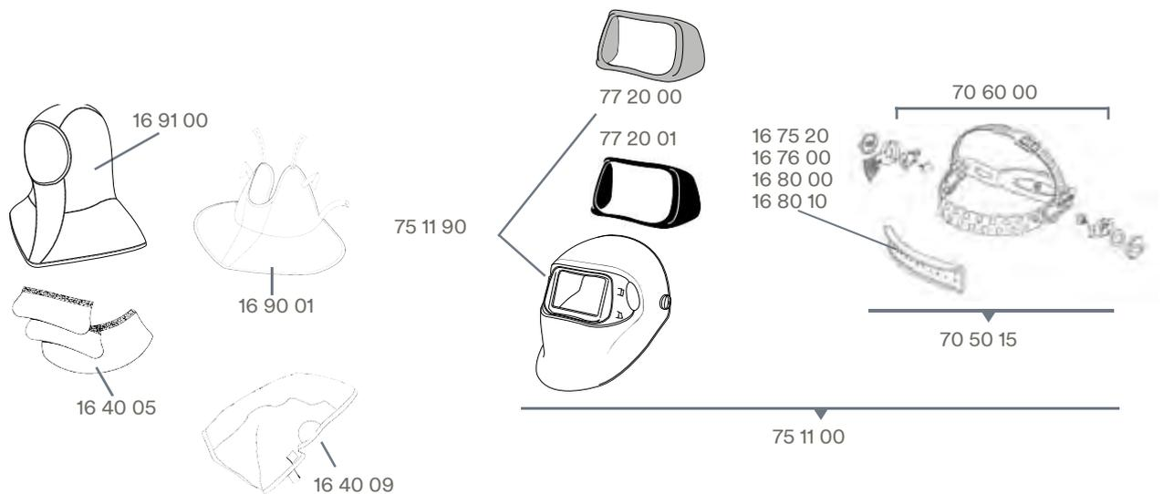
\*Ersetzt Teile-Nrn. 16 50 10 / 16 50 15 / 16 50 20 / 70 50 10. \*\*TecaWeld = Spezialgewebe aus Baumwolle und Para-Aramid.
