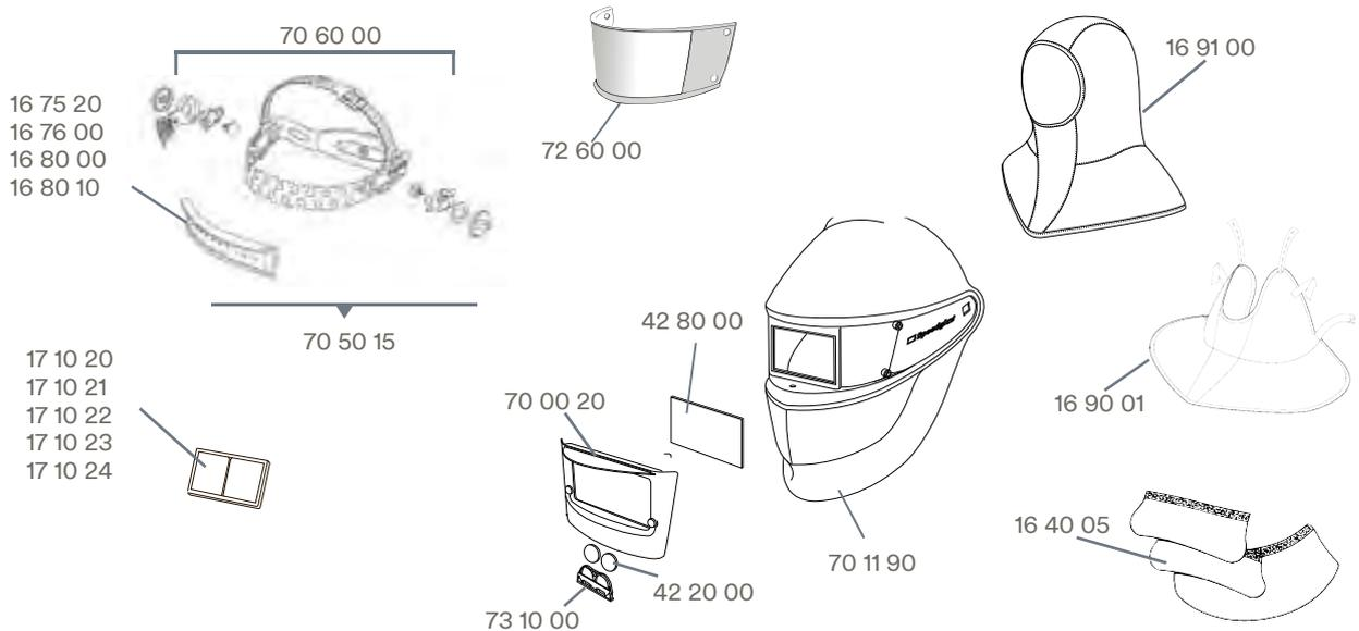
\*Ersetzt Teile-Nrn. 16 50 10 / 16 50 15 / 16 50 20 / 70 50 10. \*\*TecaWeld = Spezialgewebe aus Baumwolle und Para-Aramid.
