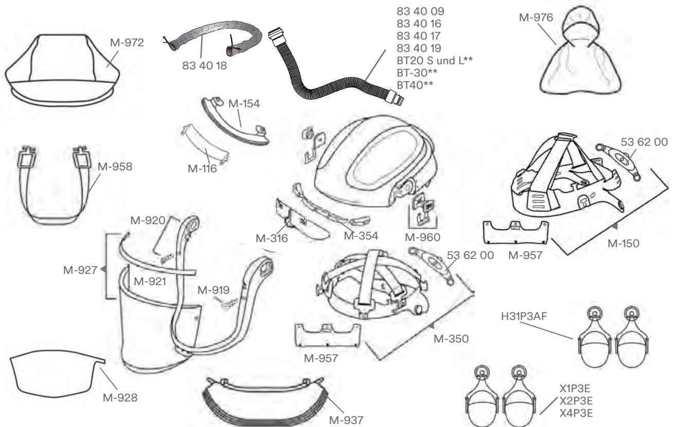
**M-300 und M-400 auch als Hitzeschutzversionen erhältlich. Komponenten für die Hitzeschutzversionen (o. Abb.): BT-927, M961, M967, M973 bzw. M975.**
